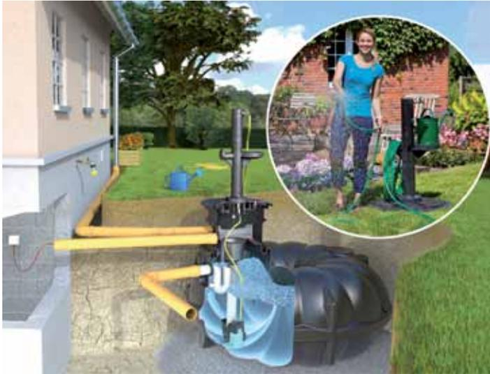
Einfacher Einbau: Regenwasser-Flach tanks der Marke Rewatec von Premier Tech.
