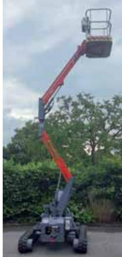
Die Schneidebühne X08 kann auch in angehobenem Zustand verfahren werden.
