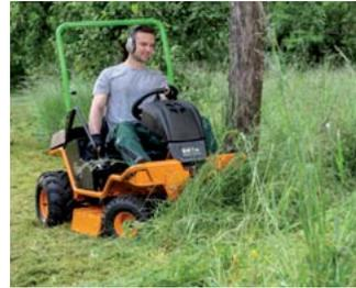
für die emissionsfreie, extensive Grünflächenpflege. Er ist mit vier 56 Volt Li-Ionen-Wechsel-Akkus und damit einer Gesamtkapazität von 16 kWh ausgestattet. Der elektrische Fahr- und Messerantrieb arbeitet hocheffizient und sorgt für eine professionelle Mähleistung, die das Niveau eines Verbrenners sogar etwas übersteigt.
